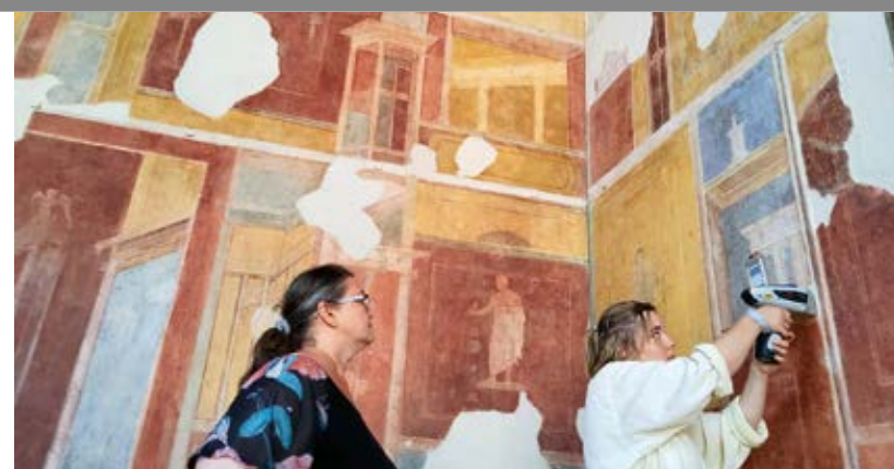
Analisi XRF (X-ray fluorescence) per l'identificazione dei pigmenti su una delle pareti dell'Insula di Giove e Ganimede nel Parco archeologico di Ostia antica
